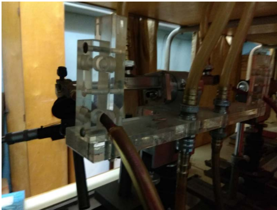
Рис. 17. Пример проточной кюветы макета лазерного счетчика-анализатора океанских гидрозоей (взвесей) конструкции Ю.В. Жуланова.
