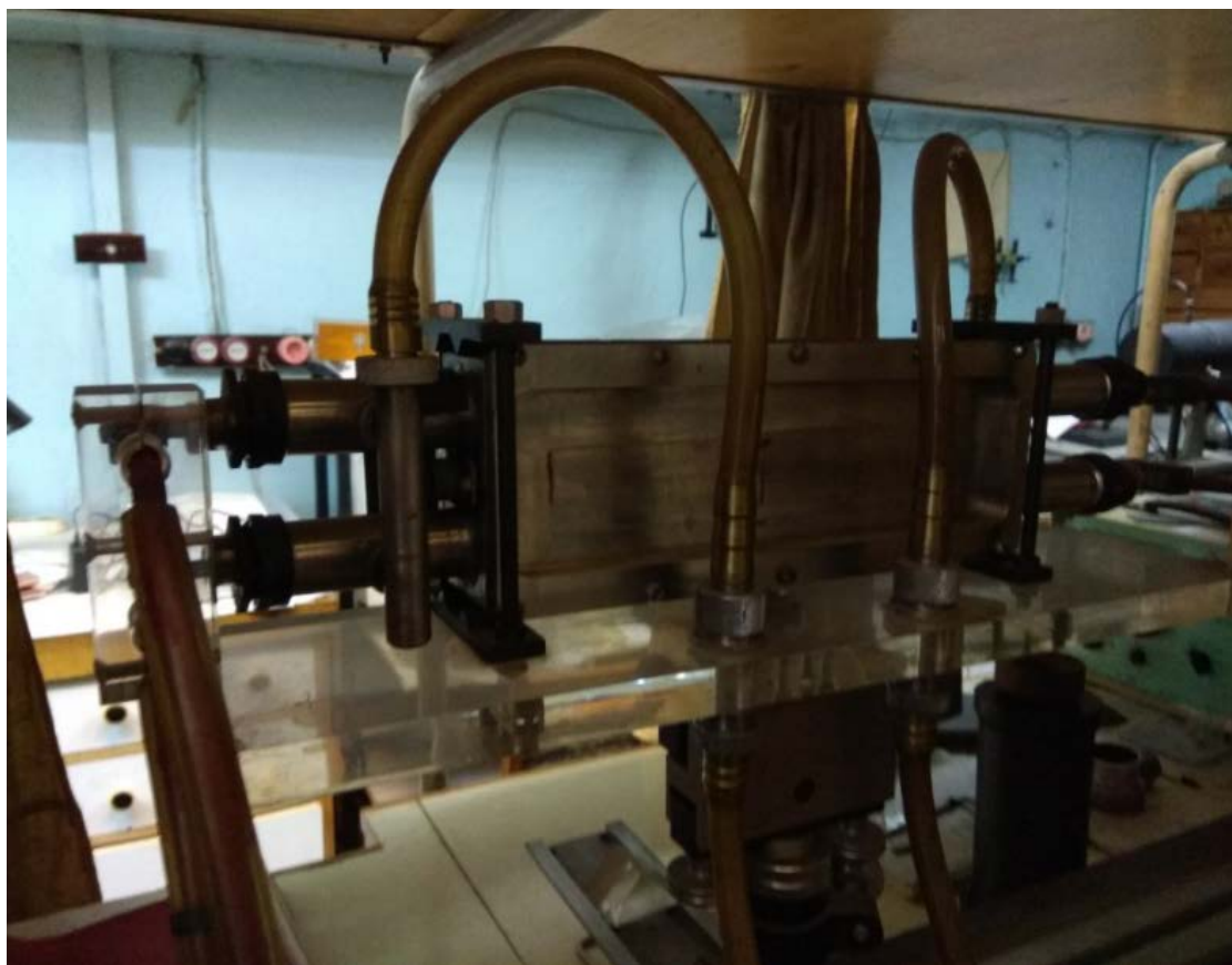
Рис. 1а. Пример проточной кюветы макета лазерного счетчика-анализатора океанских гидрозоль (взвесей) конструкции Ю.В. Жуланова
