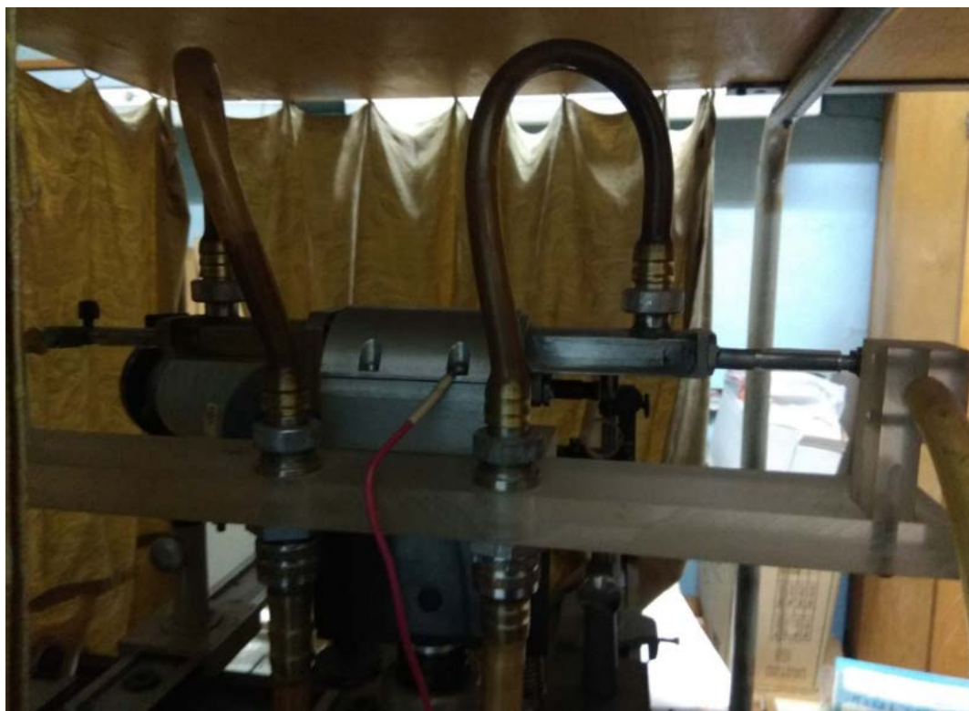
Рис. 1г. Пример проточной кюветы макета лазерного счетчика-анализатора океанских гидрозолей (взвесей) конструкции Ю.В. Жуланова
