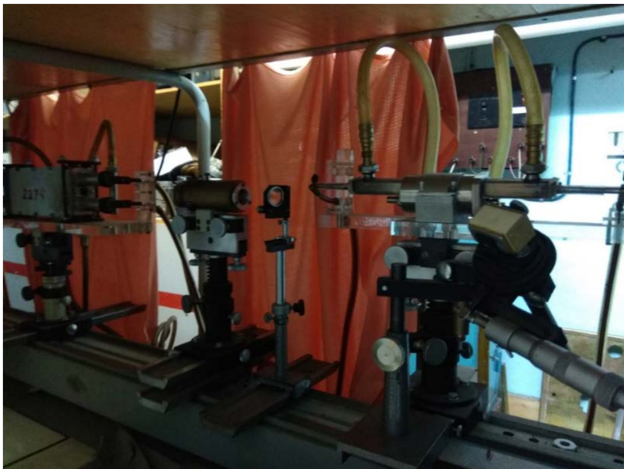
Рис. 1е. Пример проточной кюветы макета лазерного счетчика-анализатора океанских гидрозоей (взвесей) конструкции Ю.В. Жуланова
