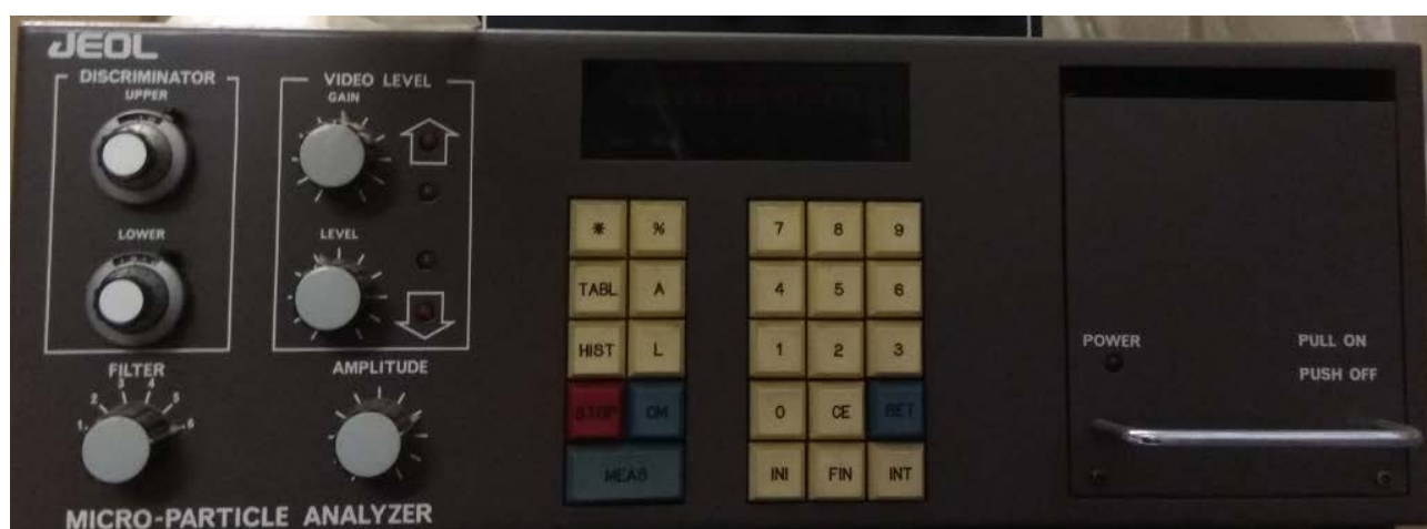
Рис. 2а. Анализатор микрочастиц JEOL MICRO-PARTICLE ANALYZER с настраиваемыми уровнями аналогового видеосигнала (VIDEO LEVEL) и дискриминации (DISCRIMINATOR). Он выдает таблицу (кнопка TABL) распределения микрочастиц по размерам и гистограмму (кнопка HIST) распределения микрочастиц по размерам. Измерение запускается кнопкой MEAS. Изображение изначально (до предлагавшейся группой О.В. Градова оцифровки) идёт через BNC-разъём на видеомонитор SM10A
