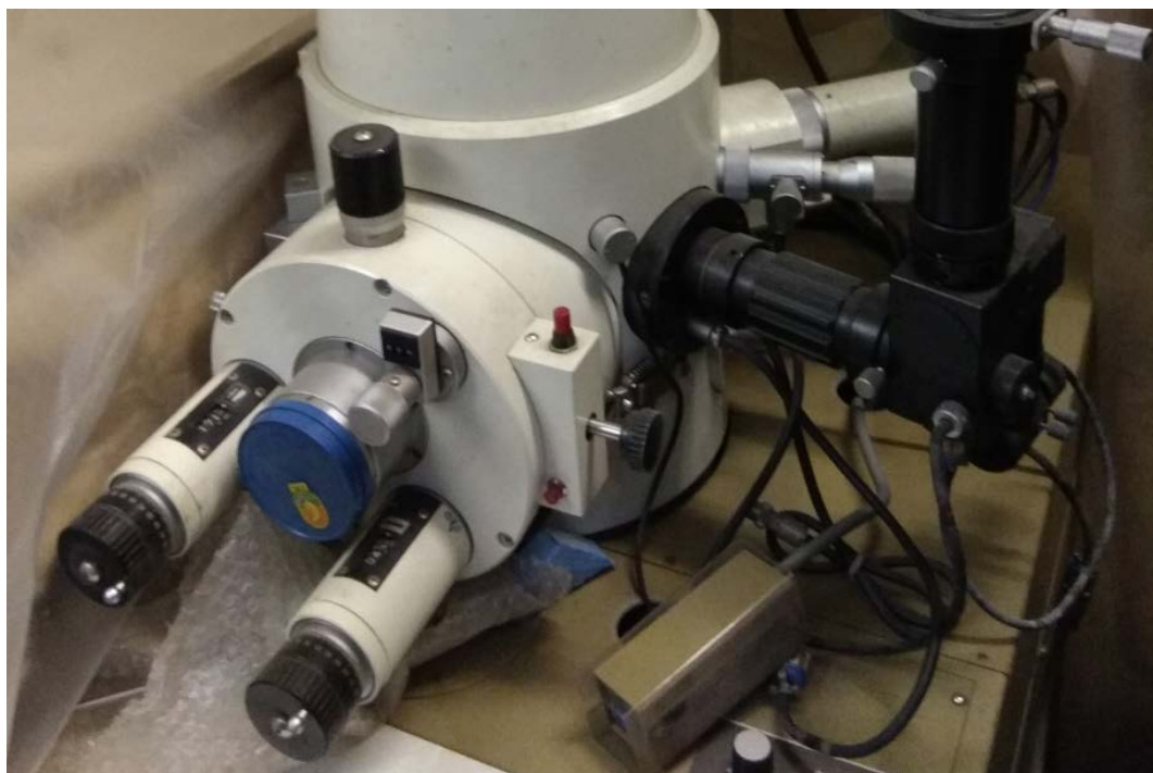
Рис. 2б. Колонна электронного микроскопа JEOL JSM-35CF и ввод светового микроскопа, который используется для позиционирования образца для рентгеноспектрального анализа на круге Роуланда. В версии модернизации, предлагавшейся группой Градова, указанный микроскоп становился основой для CLEM – корреляционной световой и электронной микроскопии (см. (Gradov, 2019; Gradov, 2023; Градов, 2023)).
