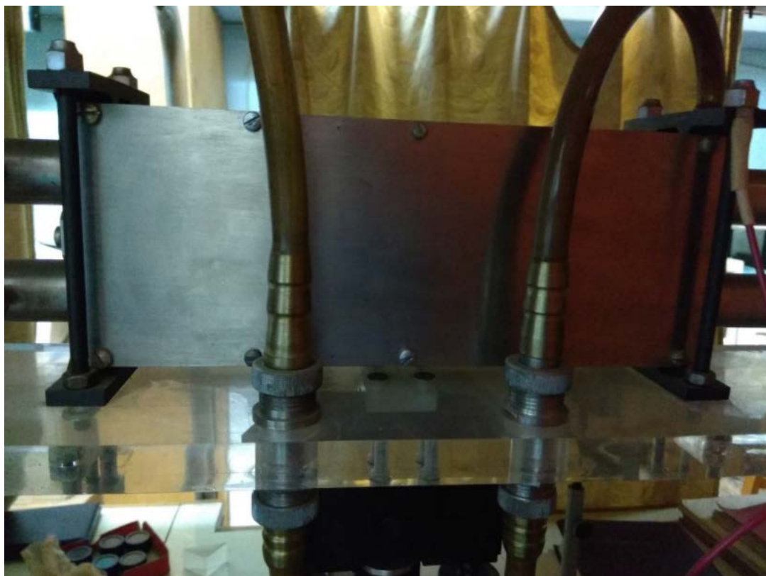
Рис. 16. Пример проточной кюветы макета лазерного счетчика-анализатора океанских гидрозоль (взвесей) конструкции Ю.В. Жуланова
